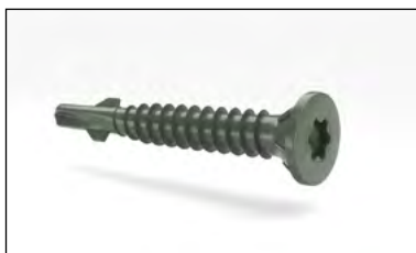
Swisspearl Universal 30 nedažyti SCR-S 4,2x30 mm paslėptam tvirtinimui prie plieninio karkaso (1,2–3,0 mm)
