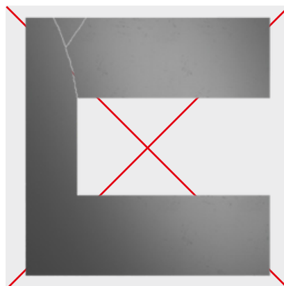
Neteisingas Hardie® Panel ir Hardie® Architectural Panel montavimas prie langų, durų ir angų.
