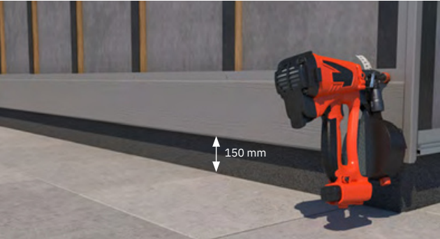
Hardie® VL Plank“ turi būti montuojama 150 mm aukščiau minkšto paviršiaus.
